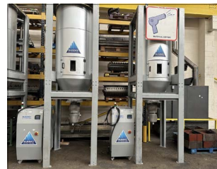
800 litre hopper with D250 55-150 deg C
